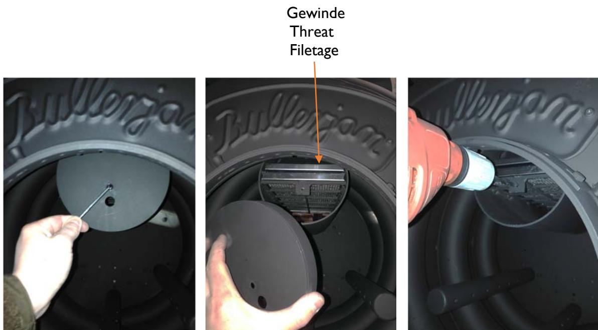
1.) Öffnen Sie die Ofentür. Lösen Sie zunächst mit einem Inbus-Schlüssel Gr. 5 die Schraube der Abdeckung des Rauchumlenkrohres.
